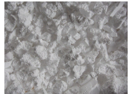
EPS vorzerkleinert/ pre-crushed
